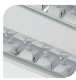
Lâmpada Fluorescente Tubular T5. Corpo em chapa de aço tratada e pintada. Painel em chapa de aço tratada e pintada. Refletor parabólico em alumínio anodizado brilhante de alta refletância e alta pureza 99,85%. Aletas parabólicas em alumínio anodizado brilhante de alta refletância e alta pureza 99,85%. Soquete tipo push-in G-5 de engate rápido, rotor de segurança em policarbonato e contatos em bronze fosforoso. Instalação de sobrepor.
