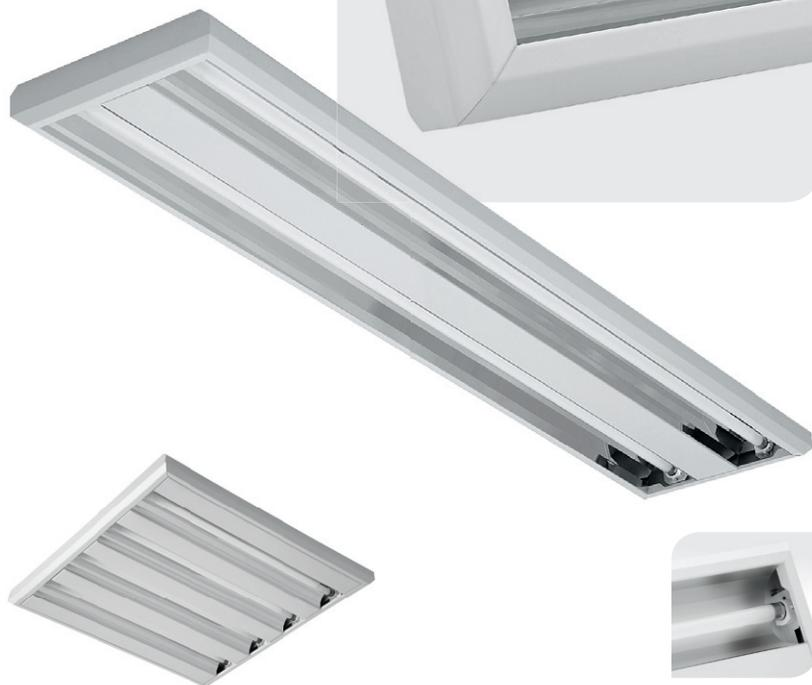
Lâmpada Fluorescente Tubular T5. Corpo em chapa de aço tratada e pintada. Pannel em chapa de aço tratada e pintada. Refletor facetado em alumínio anodizado brilhante de alta refletância e alta pureza 99,85%. Soquete tipo push-in G-5 de engate rápido, rotor de segurança em policarbonato e contatos em bronze fosforoso. Instalação de sobrepor.
